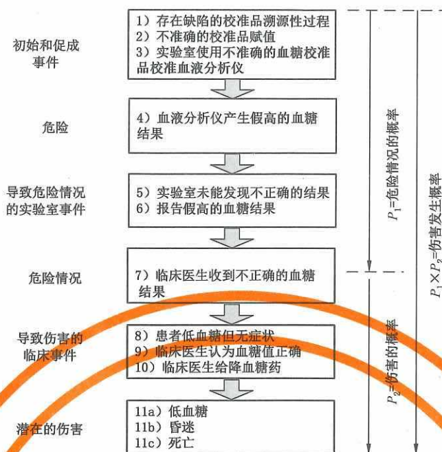
图 H.1 关于 IVD 医疗器械不正确血糖测量的实验室场景事件序列的说明
