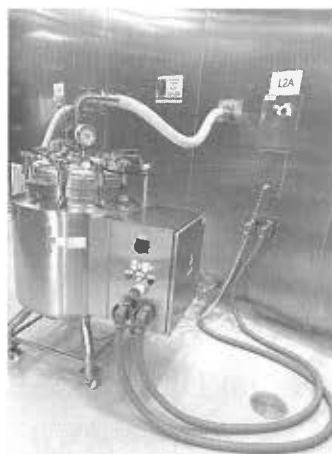
图 4-4 清洗站和被清洗容器连接示意图
