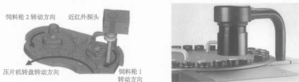
图 4-16 近红外光谱在线与线边测试在压片过程中的应用示意图
