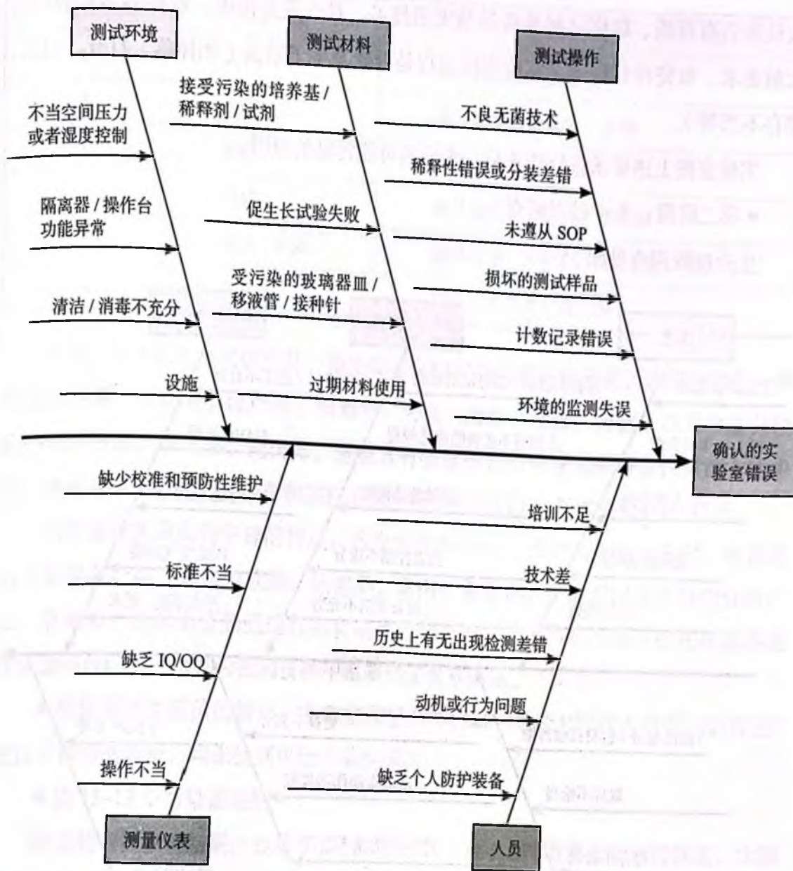
图 15-2 在微生物检测根本原因分析过程中的鱼骨图示例
