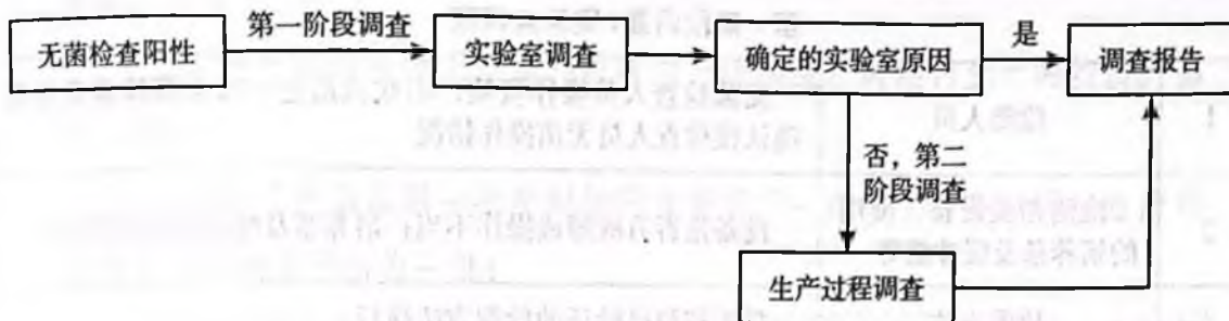
图 15-1 无菌检查阳性结果的调查流程图
