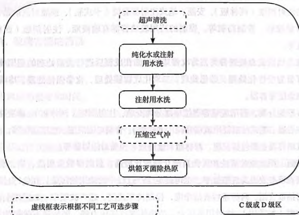
图 5-2 西林瓶清洗和准备的工艺流程图示例
