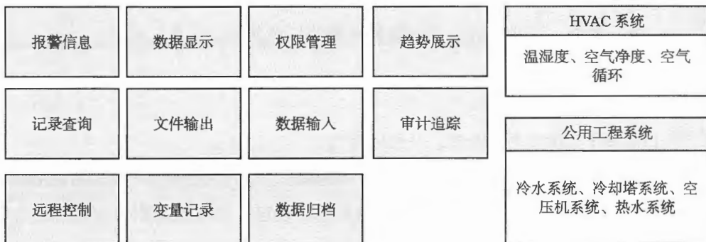
图 6-3 BMS 功能架构示例
