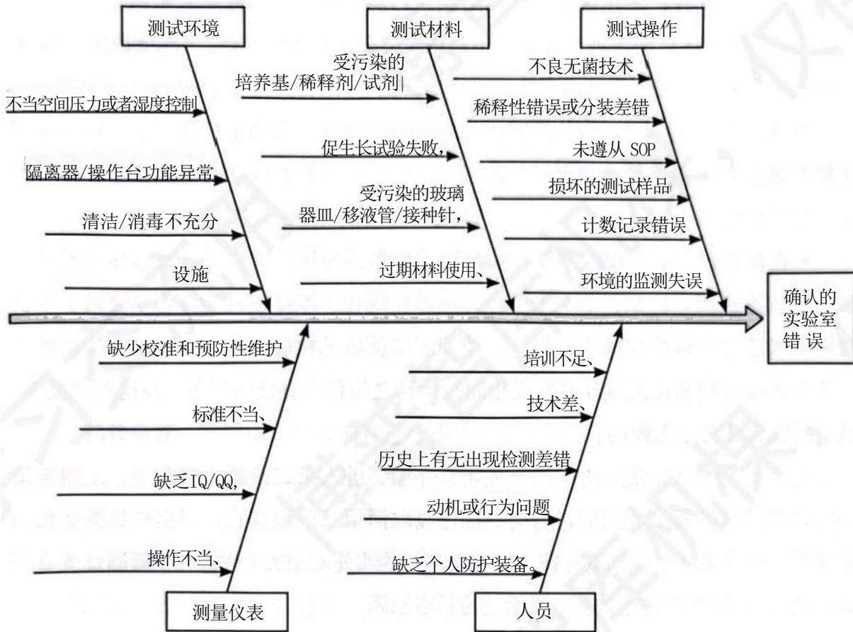
图12-2 在微生物检验根本原因分析过程中的鱼骨图示例
