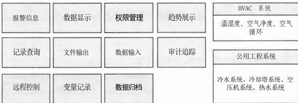
图6-3 BMS 功能架构示例
