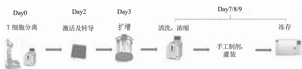
图3-2 使用密闭设备生产细胞治疗产品示意图
