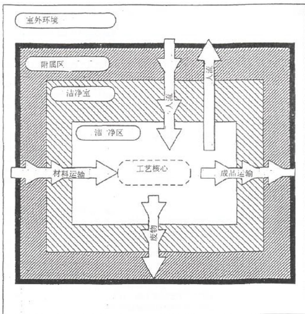
图 1 壳式污染控制概念
