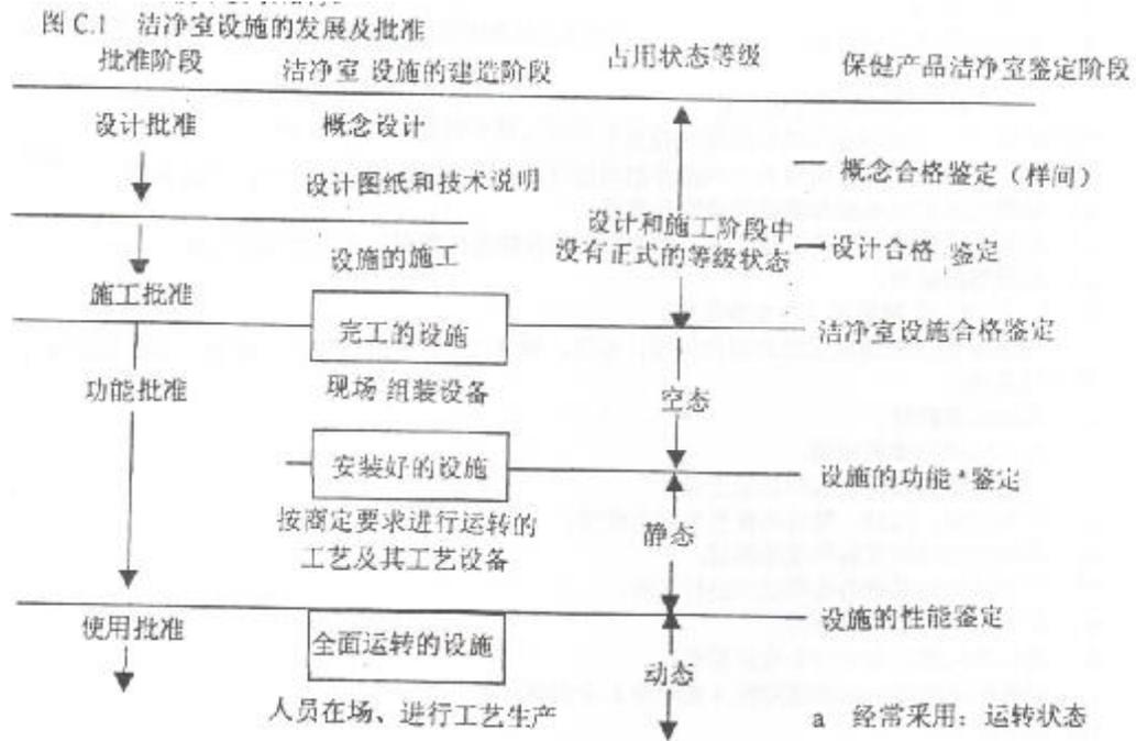
图 C.1 表明了一个设施的批准、发展阶段和正式的占用状态等级划分之间的逻辑顺序和相互关系。这里特别选了一个保健用洁净室的例子说明洁净室及与工艺相关的合格鉴定的各个阶段。
